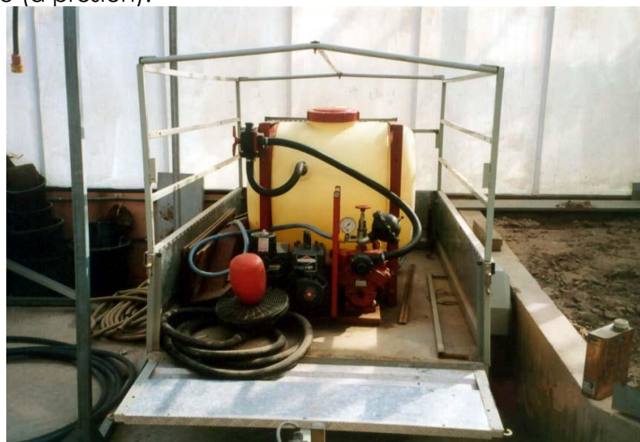
Figura 5: Remolque, tanque y bomba
