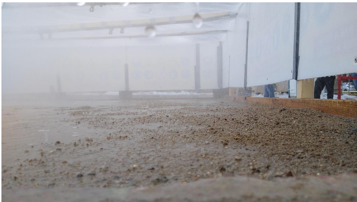
18. Imatge de la prova de pluja en curs dins del dispositiu. Font: BIMSA
