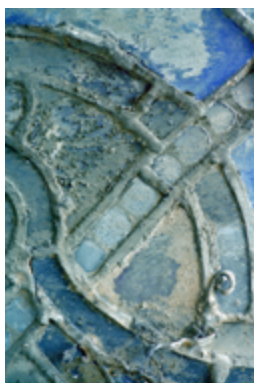
◀ Recobriment gris i restes de morter. Foto de la cara interna sense llum transmesa.
