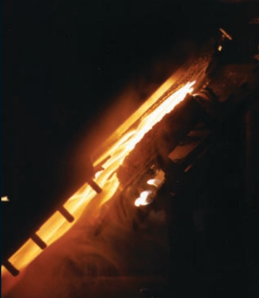
← Una prova de reacció al foc d'una catifa (norma UNE 23721). Assaig de radiació.
