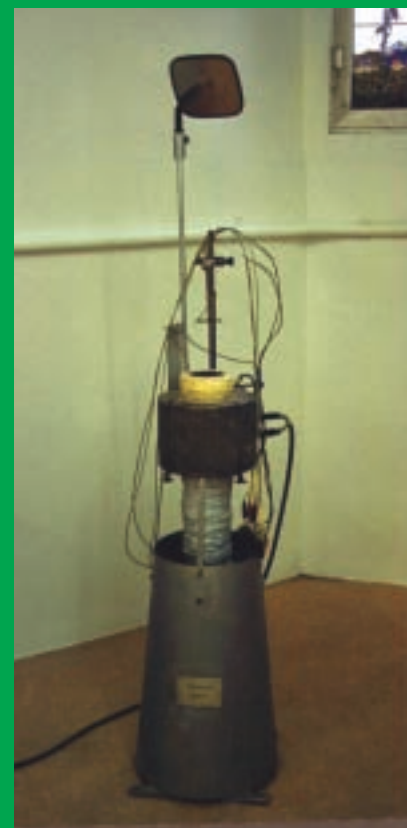
← Aparell per a l'assaig de no combustibilitat, que forma part del material cedit a la UPC
