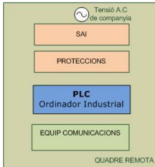
Elements del quadre d'estació remota
