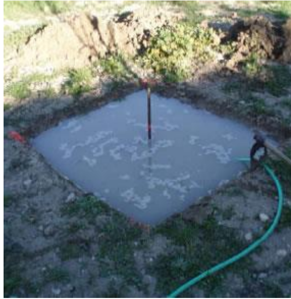
Figura 2 Assaig de permeabilitat en rasa segons el mètode de Haefeli (Font: Basalto Informes Técnicos, S.L.)
