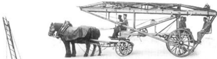
M VI 3- u. 4 teilig. Fahrstellung für Pferdezug mit 6 Sitzplätzen.
