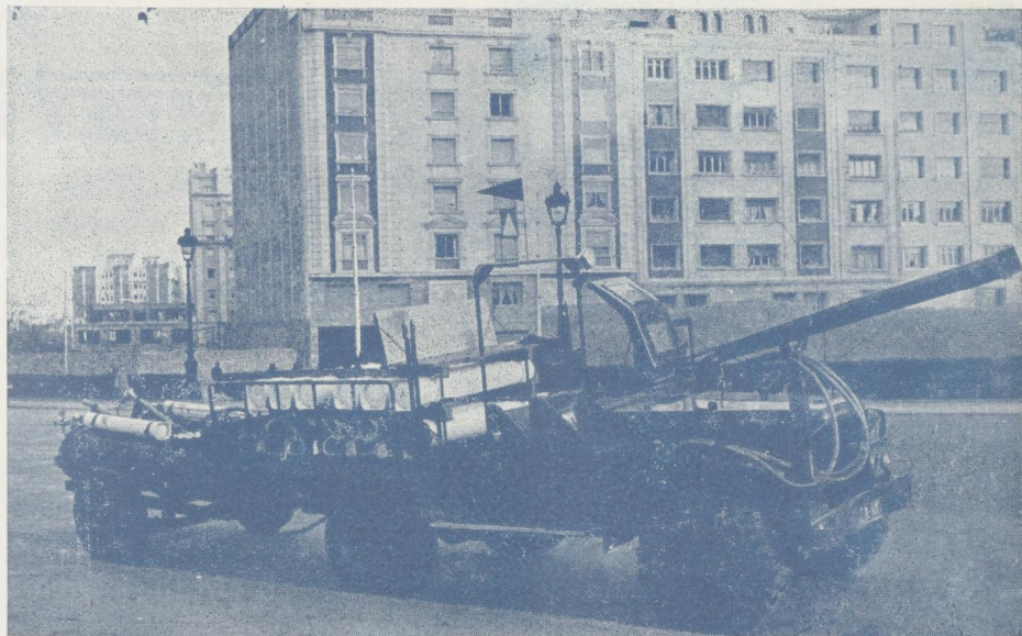
Coche extintor de incendios a base de anhídrido carbónico y espuma de aire equipado en España
