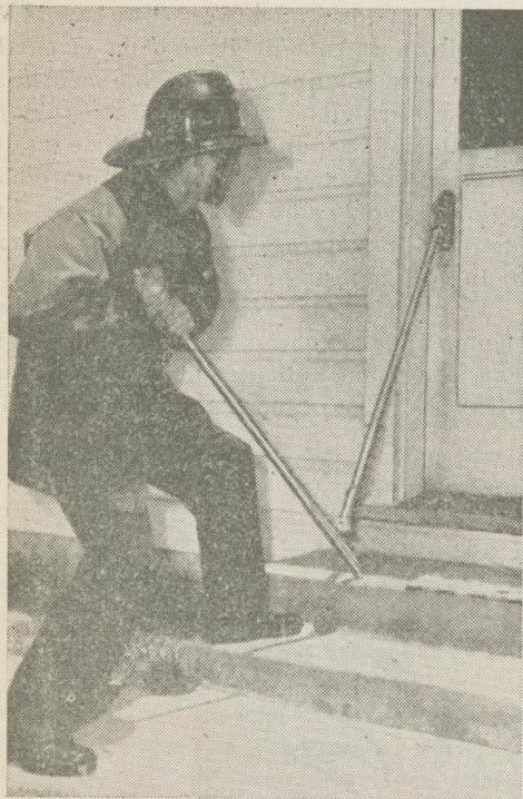
Puede ejercerse gran fuerza empleando una palanca, como lo hace este bombero al abrir una puerta,
