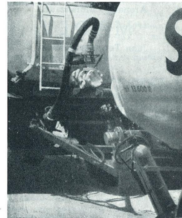
Obsérvese, a la izquierda de la escalerilla, el tubo de recirculación de vapores, prolongado desde la parte superior del depósito hasta una altura en que sea asequible para su manejo.
