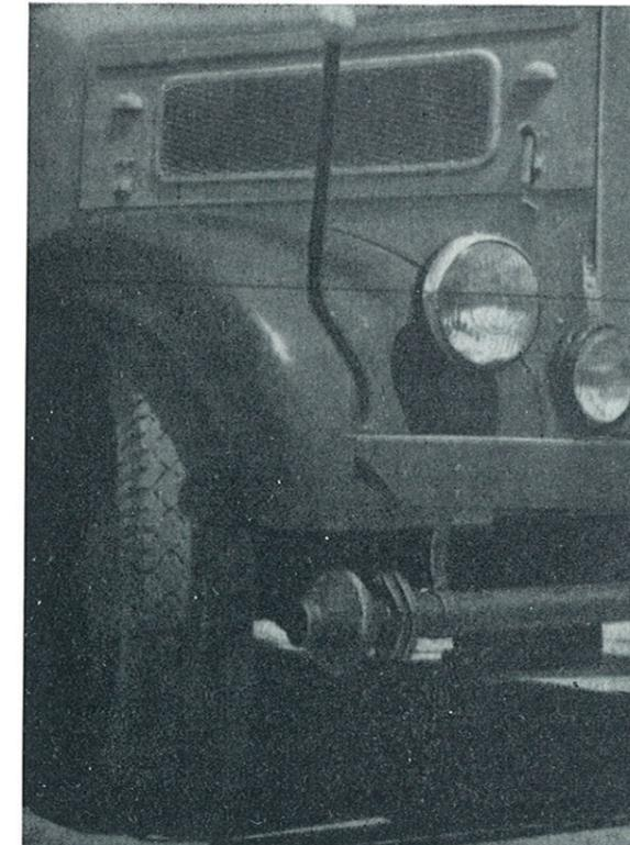
Dispositivo de seguridad contra el peligro de inflamación, montado en el tubo de escape de un camión cisterna.
