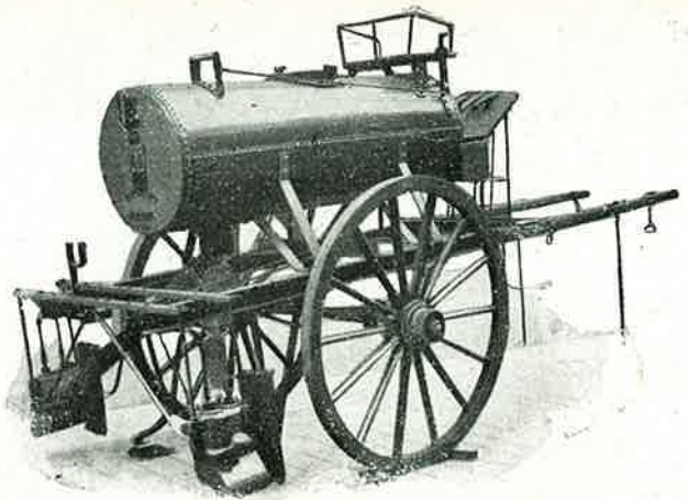
Carro de riego con dos válvulas laterales para tiro por caballería
