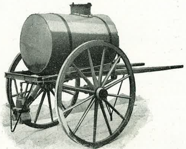
Carro de riego con válvula central para tiro a mano
