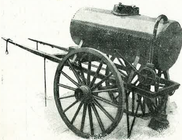
Carro de riego con válvula central y bomba para tiro por caballería
