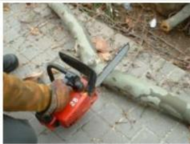
INCORRECTE - ¡PERILL! NO TREBALLEU AMB UNA SOLA MÀ!!
