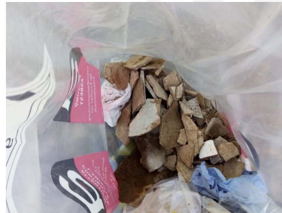
Inspecció i recollida de restes de fibrociment aflorats a conseqüència de pluges torrencials.
