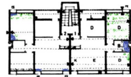
Fig. 4.3-5: Indicis d'humitats i filtracions
