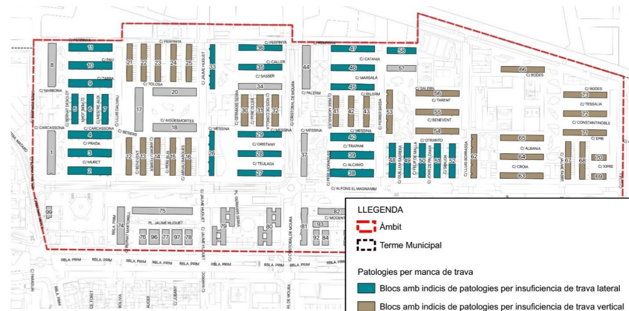
Fig. 4.3-13: Plànol amb les tipologies amb indicis de patir patologies d'insuficiència de trava
