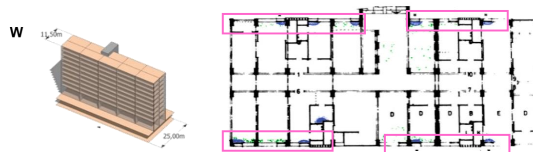
Fig. 4.3-23: Filtracions als tancaments de la tipologia W
