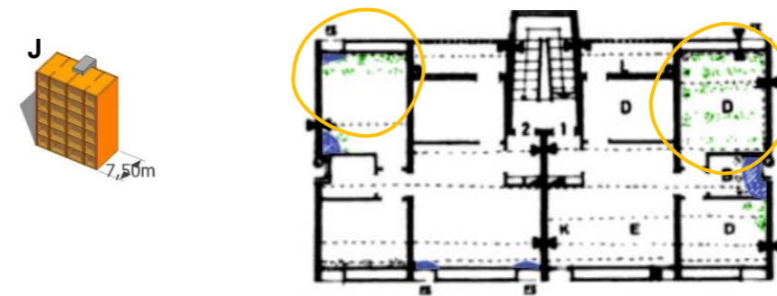
Fig. 4.3-19: Humitats de condensació en façanes orientades a N-O de la tipologia J
