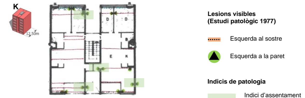
Fig. 4.3-10: Indicis d'assentaments de la tipologia K
