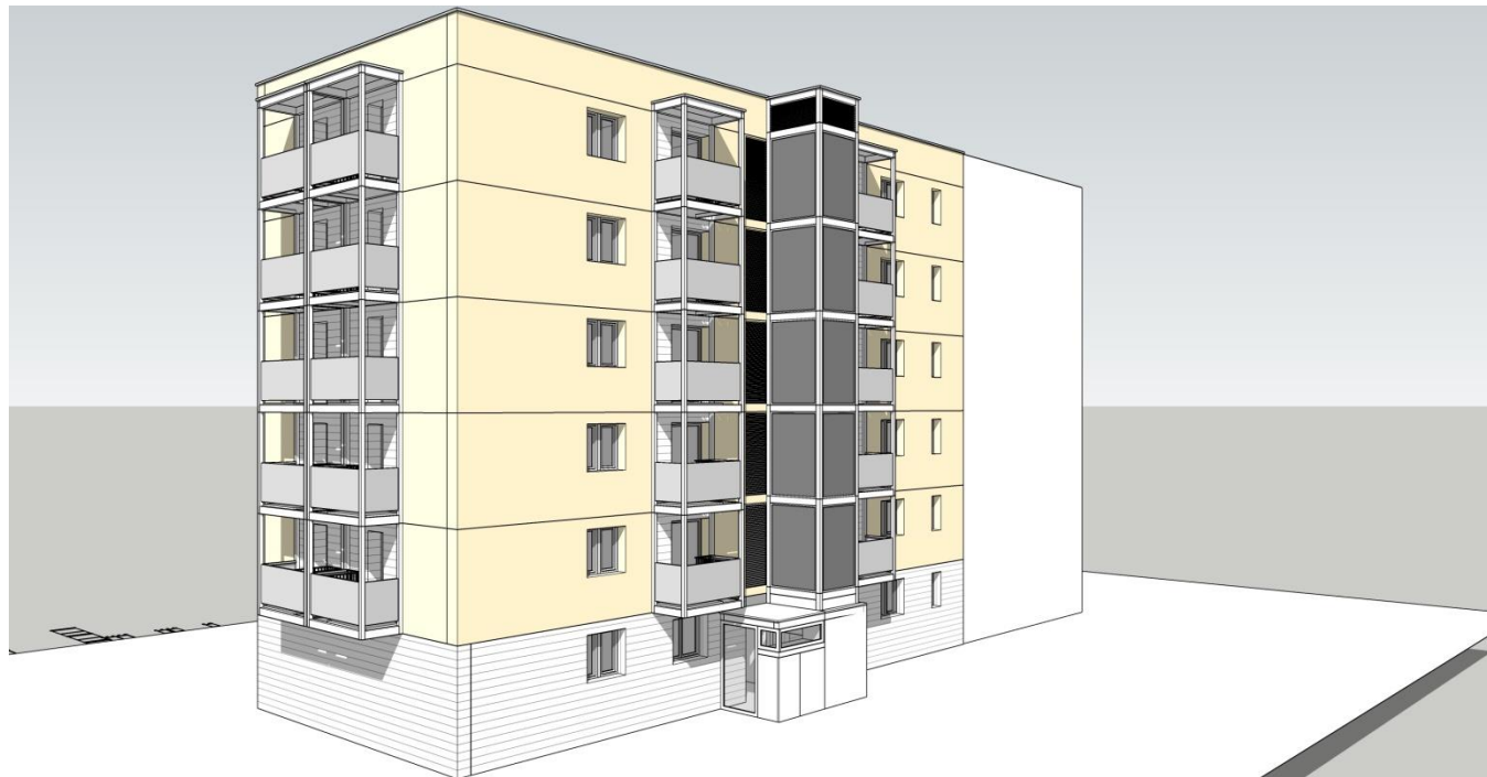
Vista d'una proposta de rehabilitació de balcons i ascensor en la façana de Benevent.
