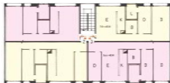
Planta model de distribució de l'habitatge: E=sala d'estar, K=cuina, B=Bany, L=Safareig, D=Dormitori
