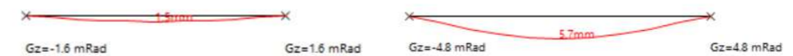
Deformacions (mm) de la barra trencallums (esquerra) i del tub longitudinal principal (dreta), en ELS
