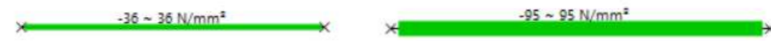
Tensions (N/mm 2 ) de la barra trencallums (esquerra) i del tub longitudinal principal (dreta), en ELU
