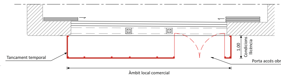
PLANTA TANCAMENT D'OBRA SOBRE VÍA PÚBLICA
