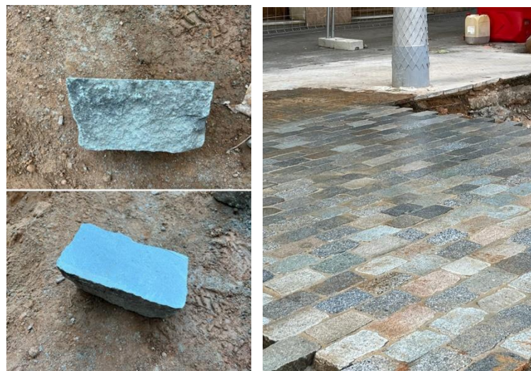
A les dues fotos de l'esquerra, llambordes amb el tractament aplicat per allisar-les, i a la dreta un àmbit dels eixos verds on s'ha testejat el paviment amb llambordes tractades.
