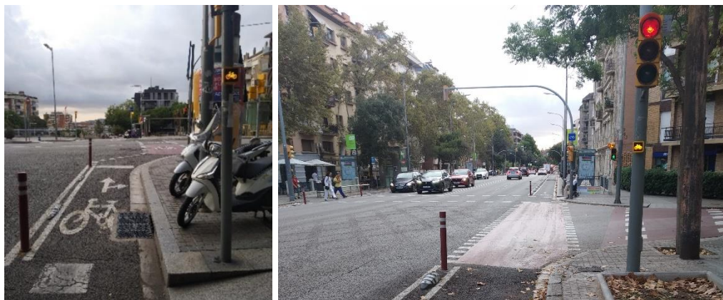
Fig. 49: Exemples de semàfors en ambre intermitent per al filtratge en ens passos de vianants; Font: AIM, elaboració pròpia
