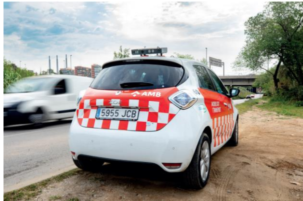
Fig.26. Vehicle de la AMB amb sistema de càmeres de control instal·lades. Font: Guia tècnica per implementar zones de baixes emissions AMB
