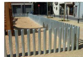
TANCA METÀ-LICA MODEL PARC FORMADA PER UNITATS DE 12 TUBS DE 80mm DE DIAMÈTRE SEPARATS 80mm, SOLDATS A PASSAMA 120x180mm de 8mm de gruix FIXAT AMB VARILLES O CARGOLS, ACABAT GALVANITZAT EN CALENT E: 1/50
