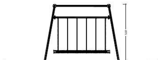
J-1.5 GRONXADOR AMB CORDA. (1 UT) DISTINAT A EDJATS A PARTIR DE 6 ANYS. JOC AMB ESTRUCTURA PRINCIPAL D'ACER GALVANITZAT QUE SUSTENTA PER DIVERSOS PUNTS UNA CORDA GRUJEUADA DE FIBRES NATURALS. Et: 1/100
