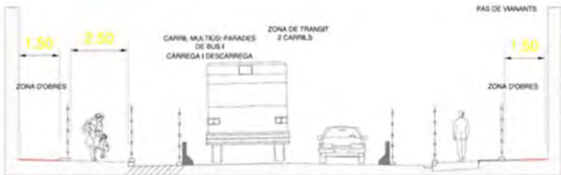
FASE 3 EXECUCIÓ VORERES INTERIORS GRÀCIA
