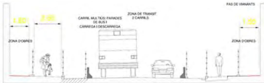
Fase 3: Execució voreres interiors Gràcia
