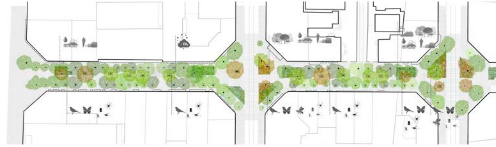
Un verd estructural, divers i resilient. 15-25M3/arbre de sòl interconnectat que permet reposicionar arbres a 7-8M façana. Els parterres busquen posicions més assolellades properes als xamfrans.
