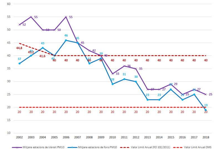
Evolución de la inmisión media anual de \text{PM}_{10} en las estaciones de la XVPCA de Barcelona [ \mu\text{g}/\text{m}^3 ]
