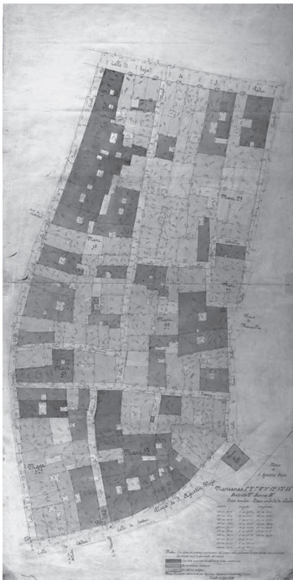
Full del plànol parcel·lari de Barcelona aixecat per l'arquitecte Miquel Garriga i Roca els anys 1859-1862, corresponent a l'entorn del carrer de Jaume Giral i les Basses de Sant Pere, que permet veure la permanència de la parcel·lació d'origen medieval i una variada gamma de configuracions arquitectòniques.
