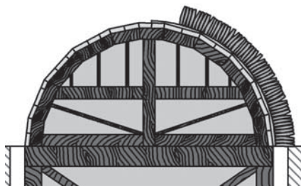
Esquema d'un arc al sardinell. La fotografia ens mostra un arc d'aquest model constructiu corresponent a una de les portes del pas de ronda de la muralla romana del Baix Imperi, segles iv-v, descoberta el 2004 a la torre núm. 29 (c. Lledó, núm.7).
